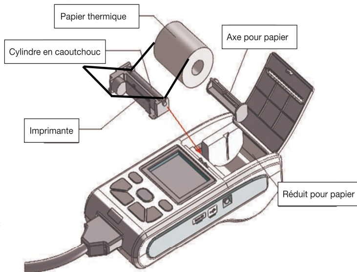
Schéma du chargement du rouleau de papier d'enregistrement
